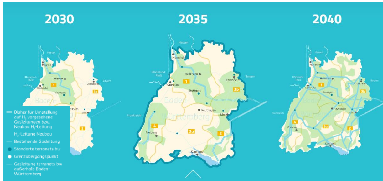
Abbildung 21: Strategie der terranets bw für den Ausbau bzw. Umbau des Wasserstoff-Kernetzes in Baden-Württemberg
